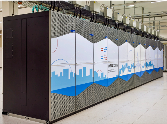
Meluxina (LU) Atos BullSequana XH2000 12 PFlops HPL AMD EPYC NVIDIA Ampere A100
