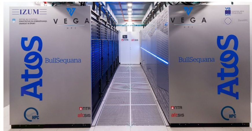
Vega (SI) Atos BullSequana XH2000 6.9 PFlops HPL AMD EPYC NVIDIA Ampere A100
